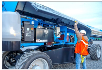
Tägliche Sicht- und Funktionsprüfung der Hubarbeitsbühne.
