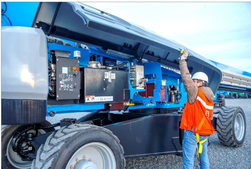
Tägliche Sicht- und Funktionsprüfung der Hubarbeitsbühne.
